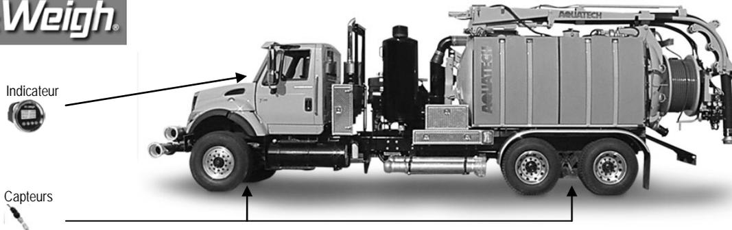
Les systèmes de balance pour camion Air-Weigh® offrent une indication précise et facile à lire des poids par essieu et du poids total
